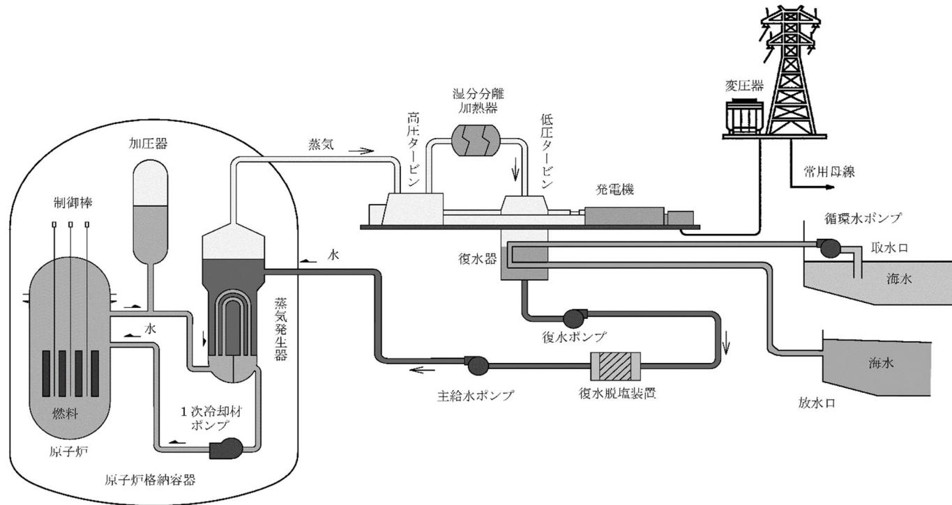
第 1.1-1 図 玄海 4 号機の系統概要図
