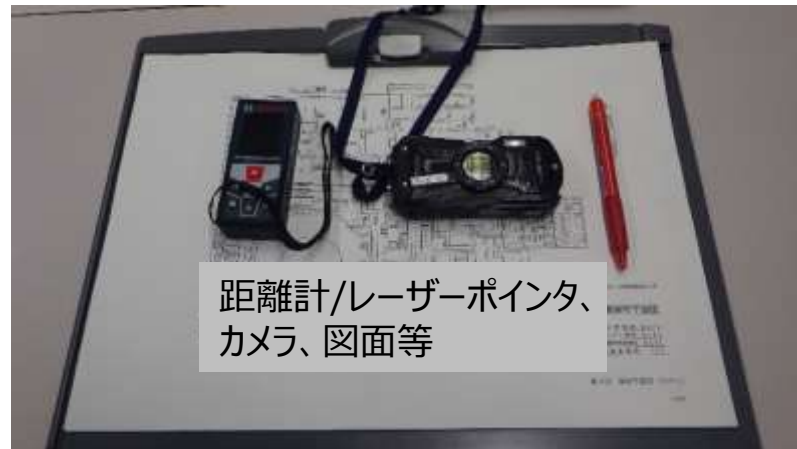
現場確認に使用したツールの例
