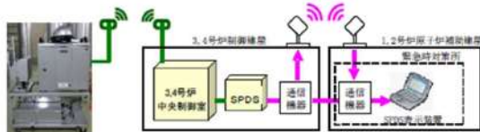
図2-3-2 可搬式モニタリングポスト伝送概略図
