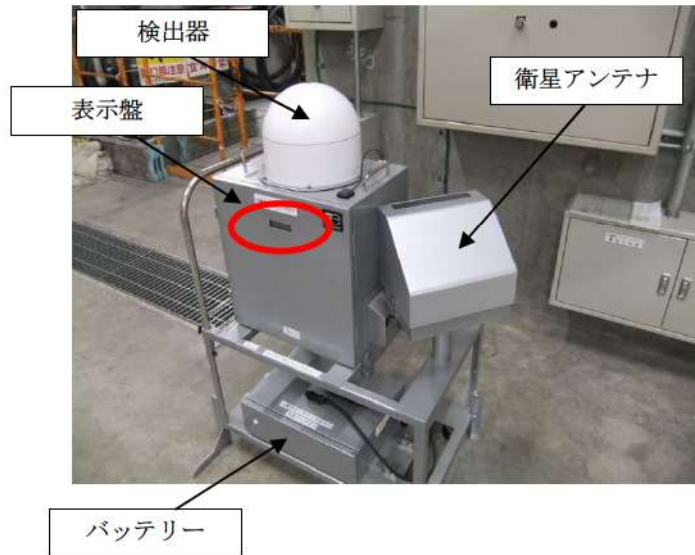
図2 可搬型モニタリングポスト 装置イメージ
