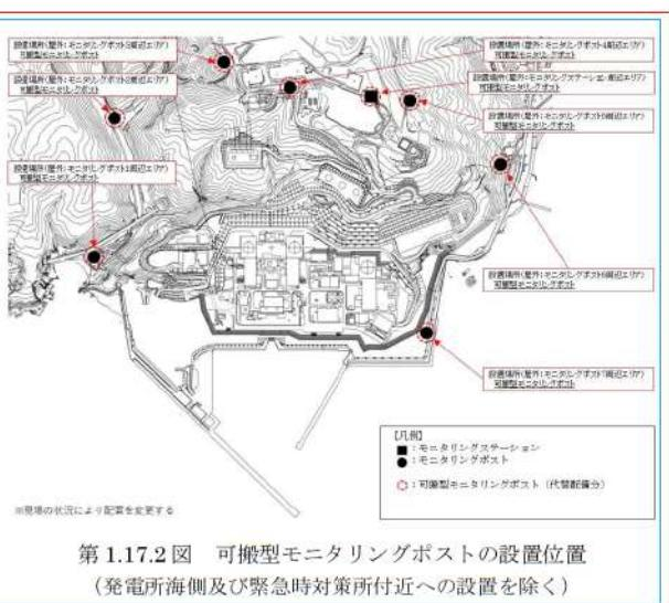
第1.17.2図 可搬型モニタリングポストの設置位置
