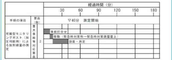
第1.17-5図 可搬型モニタリングポスト（加圧判断用）による放射線量の測定のタイムチャート
