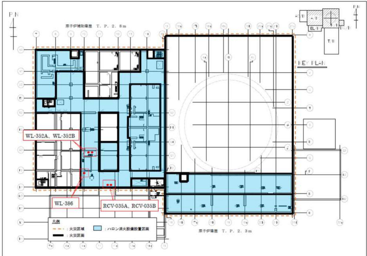
図-3 液体廃棄物放出ライン空気作動弁配置図
