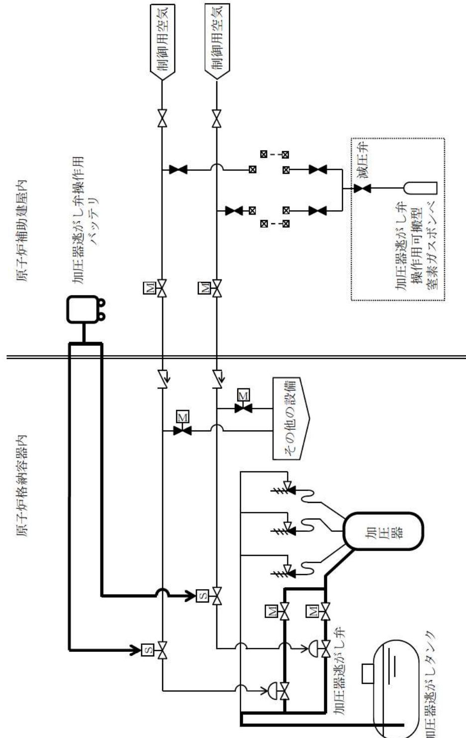
第5.5-8 図 原子炉冷却材圧力バウンダリを減圧するための設備
