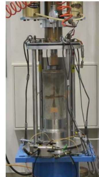
一軸圧縮試験の状況
