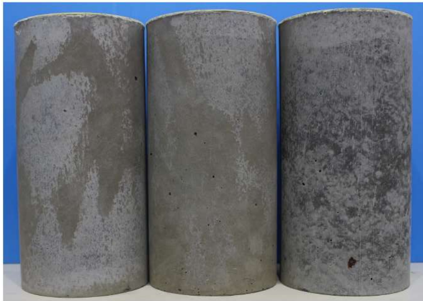
一軸圧縮試験用供試体 (φ 150mm, H300mm)
