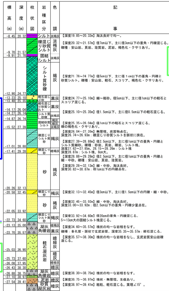
ボーリング柱状図 (深度20~40m)
