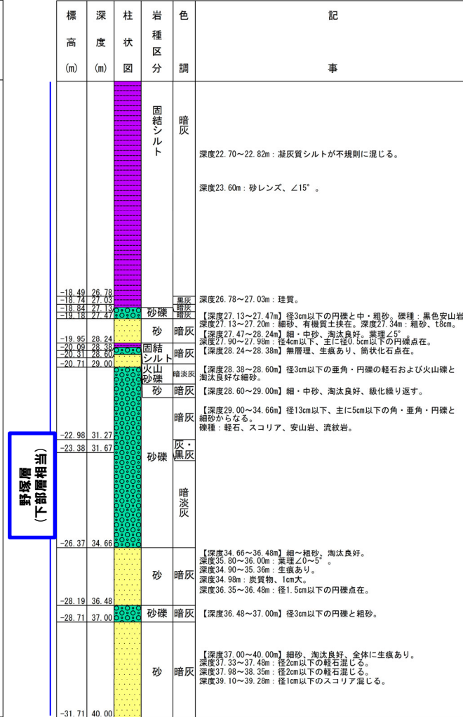
ボーリング柱状図 (深度20~40m)
