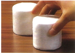
ガラス原料(ガラスファイバークार्टリッジ) ⇒2号溶融炉でも使用しているガラス原料であり、 高放射性廃液をしみ込ませて溶融炉に供給
