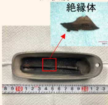
試験後 (1000°C水素ガス環境下)
