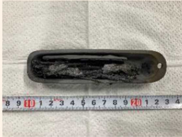
試験後 (1000°C水素ガス環境下)
