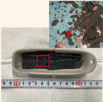
試験後 (1000°C水素ガス環境下)
