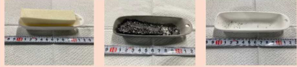
試験前 試験後 (1000°C水素ガス環境下) 試験後 (1000°C水蒸気環境下)
