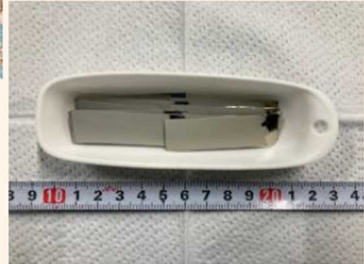
試験後 (200°C水蒸気環境下)
