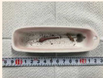
試験後 (1000°C水蒸気環境下)
