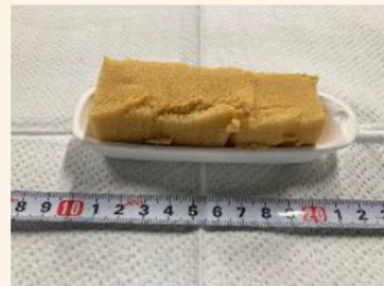
試験後 (200°C水素ガス環境下)
