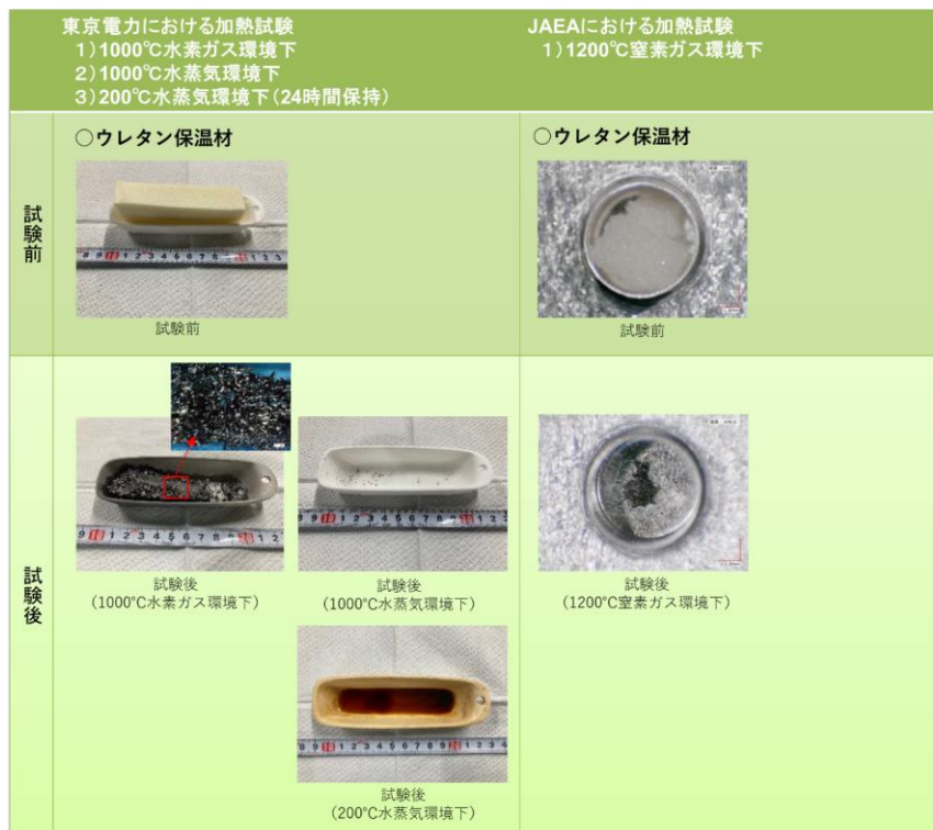
図8 東京電力及びJAEAにおける加熱試験（ウレタン保温材の例）
