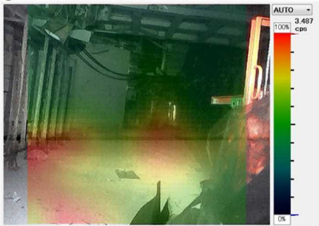
図 3 ガンマカメラによる測定結果（3号機原子炉建屋1階）
