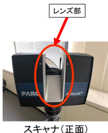
図4 3Dレーザースキャナのレンズ部
