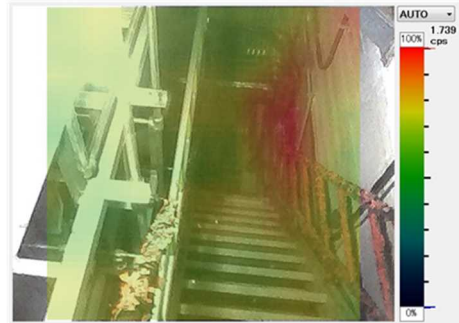
図 3 ガンマカメラによる測定結果（3号機原子炉建屋1階）
