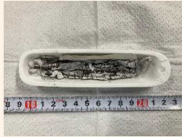
試験後 (1000°C水蒸気環境下)
