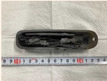
試験後 (1000°C水素ガス環境下)
