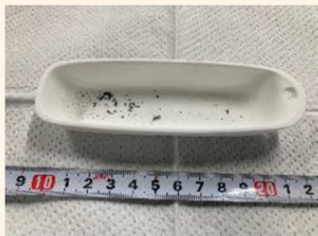
試験後 (1000°C水蒸気環境下)
