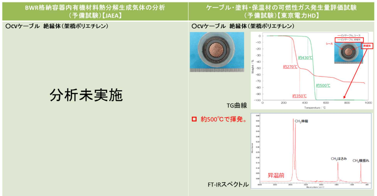
図 27-2 CV ケーブルの結果概要
