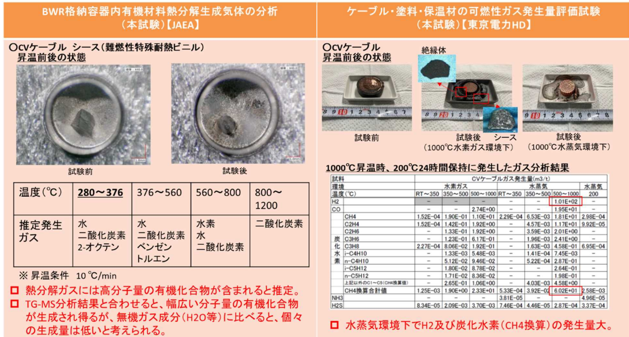
図 27-3 CVケーブルの結果概要
