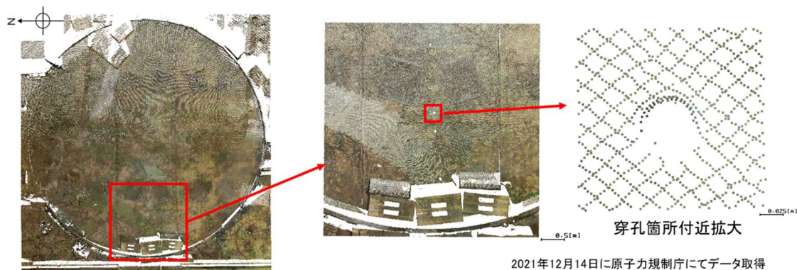
図2 取得した点群データの例（1F2号機のシールドプラグ上層上面の形状）
