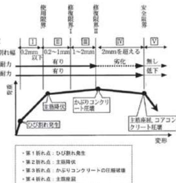
第I.2.1-3図 曲げ降伏先行型の部材の復元力特性と限界状態(損傷度)の概念図(建築学会に加筆)
