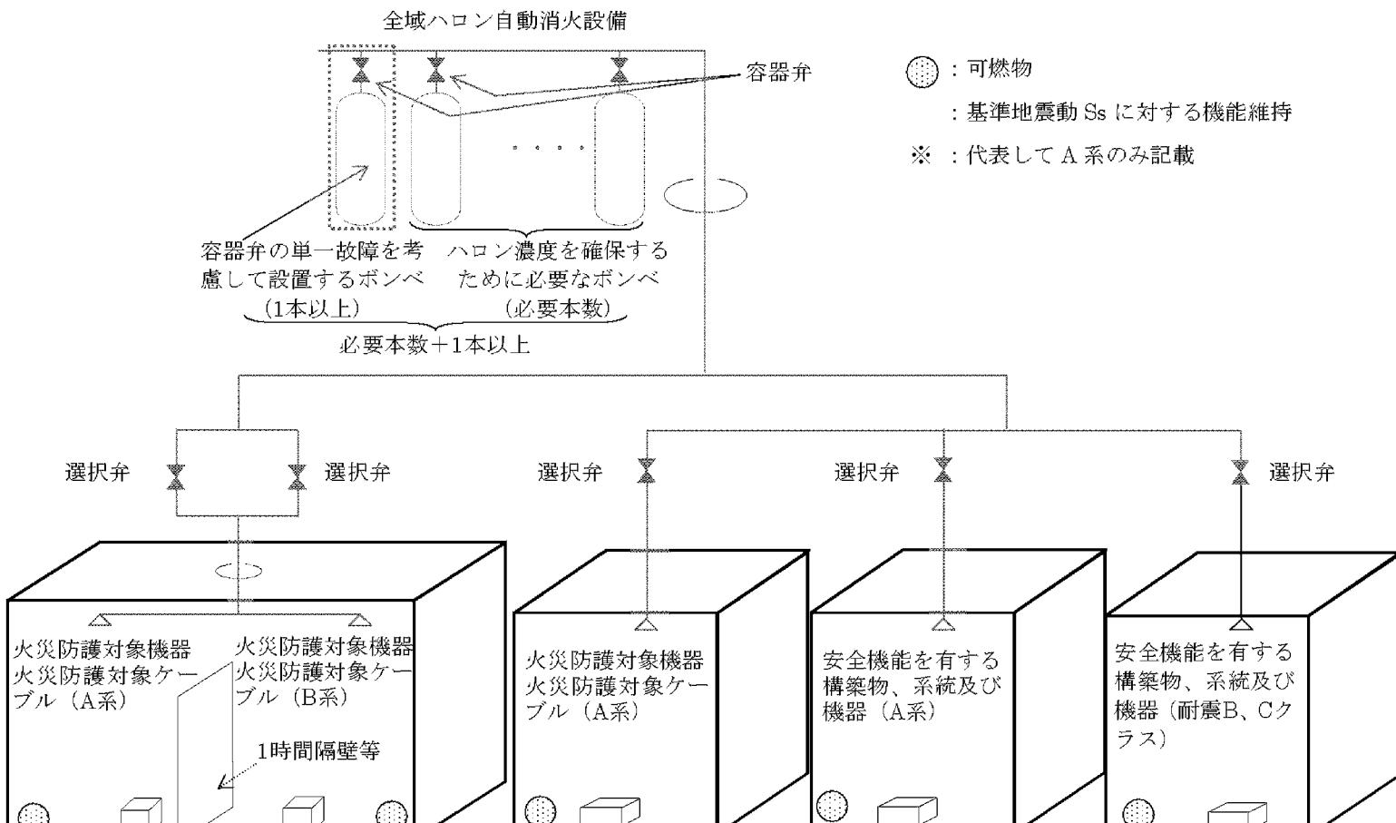
第1図 統系分離に応じた独立性を考慮した全域ハロン自動消火設備概要図
