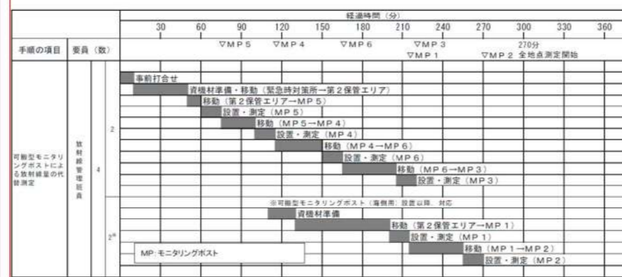
第1.17-3図 可搬式モニタリングポストによる放射線量の代替測定のタイムチャート
