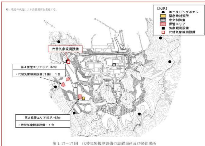
第1.17-17図 代替気象観測設備の設置場所及び保管場所
