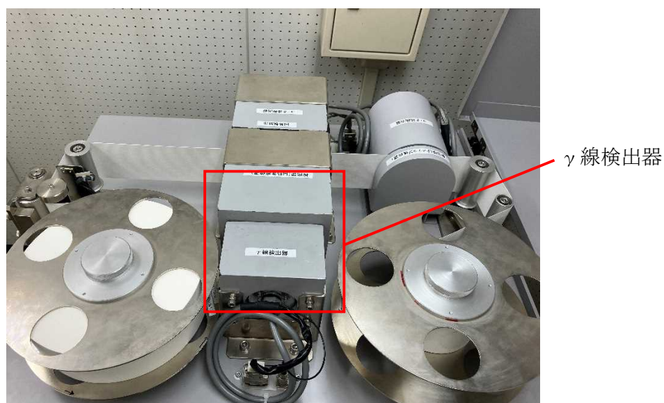
写真C-1 ヨウ素モニタの検出部の例
