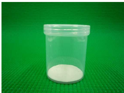
写真 2-4 小型容器への試料の充填
