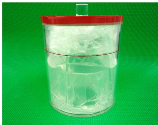
写真 2-11 ビニールテープによる蓋の固定
