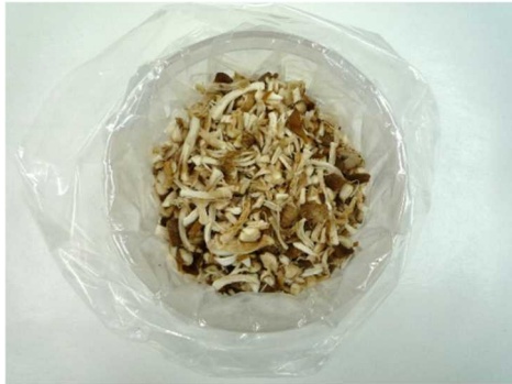
写真 2-21 マリネリ容器への試料の充填 (シイタケ)
