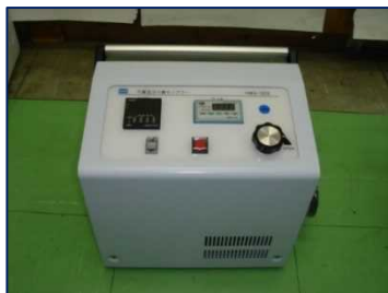
写真 2-3 ローボリウムエアサンプラの例
