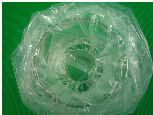
写真 2-8 マリネリ容器への試料の充填
