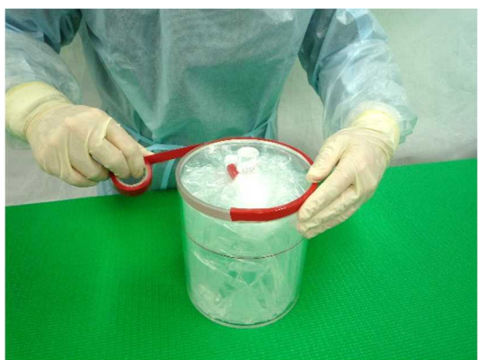
写真 2-10 ビニールテープによる蓋の固定
