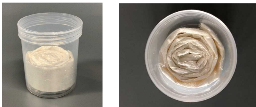
写真 2-7 6時間分に切り取った長尺ろ紙を充填した例
