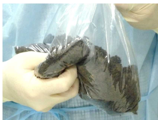
写真 2-17 試料の攪拌・混合
