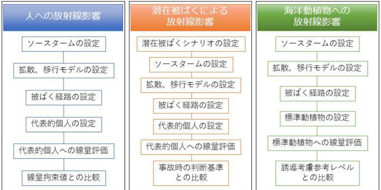
IAEA安全基準のガイドGSG-10に示される評価フロー
