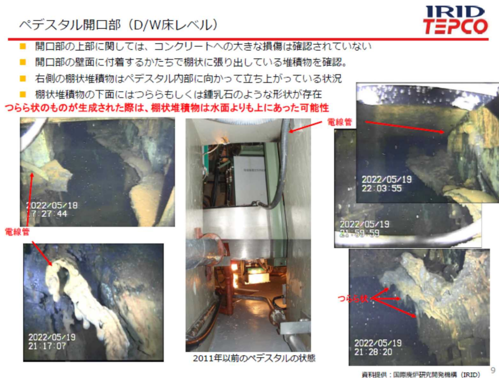
図 21-1 ペDESTAL開口部 (D/W 床レベル) ①
