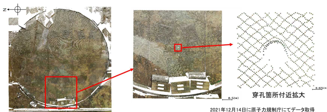
図2 取得した点群データの例（1F2号機のシールドプラグ上層上面の形状）
