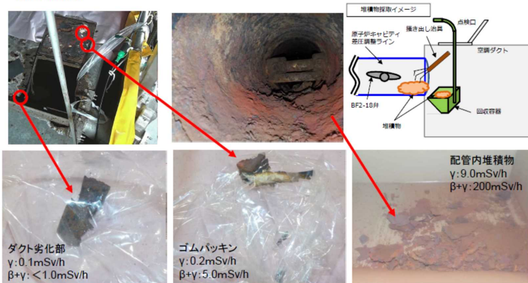
図4 2号機西側原子炉キャビティ差圧調整ライン調査 (サンプル採取)
