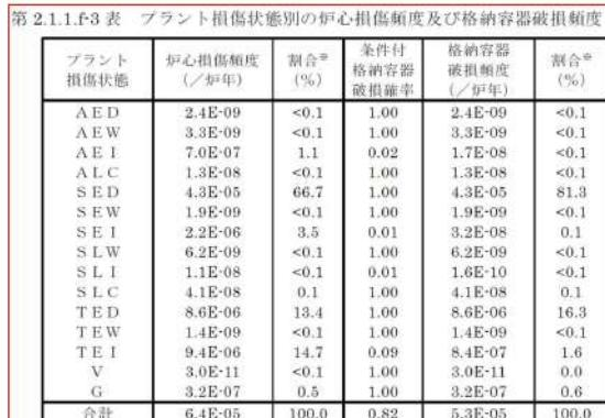
第4.1.1.f-3表 プラント損傷状態別の炉心損傷頻度及び格納容器破損頻度
