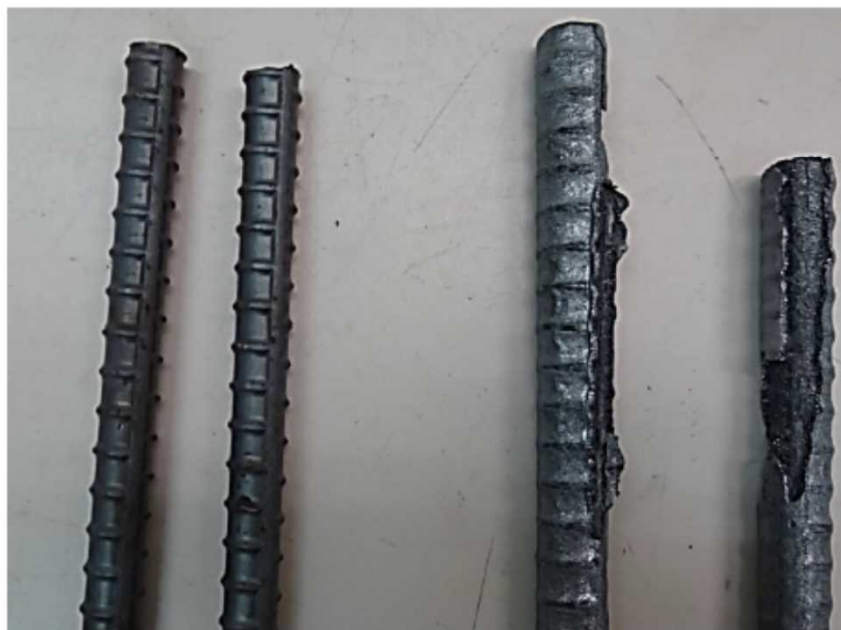
鉄筋D10 (600度8時間) 加熱前と比較して変化なし
