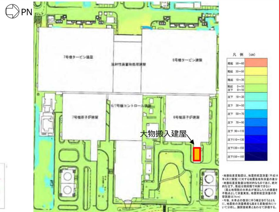
図33 中越沖地震後の地盤鉛直変動図※
