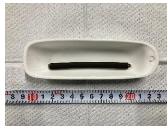
試験後 (200°C水蒸気環境下)
