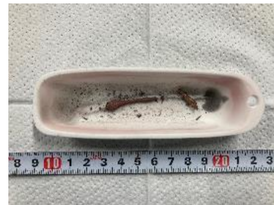
試験後 (1000°C水蒸気環境下)
