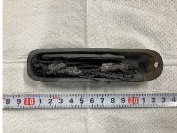
試験後 (1000°C水素ガス環境下)
