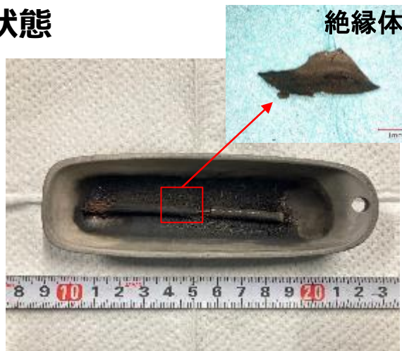
試験後 (1000°C水素ガス環境下)
