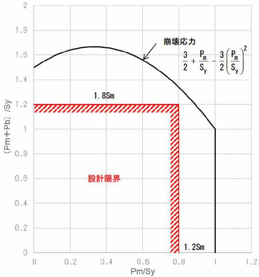
図 6 供用状態 C における引張及びび曲げによる崩壊応力及び設計限界
