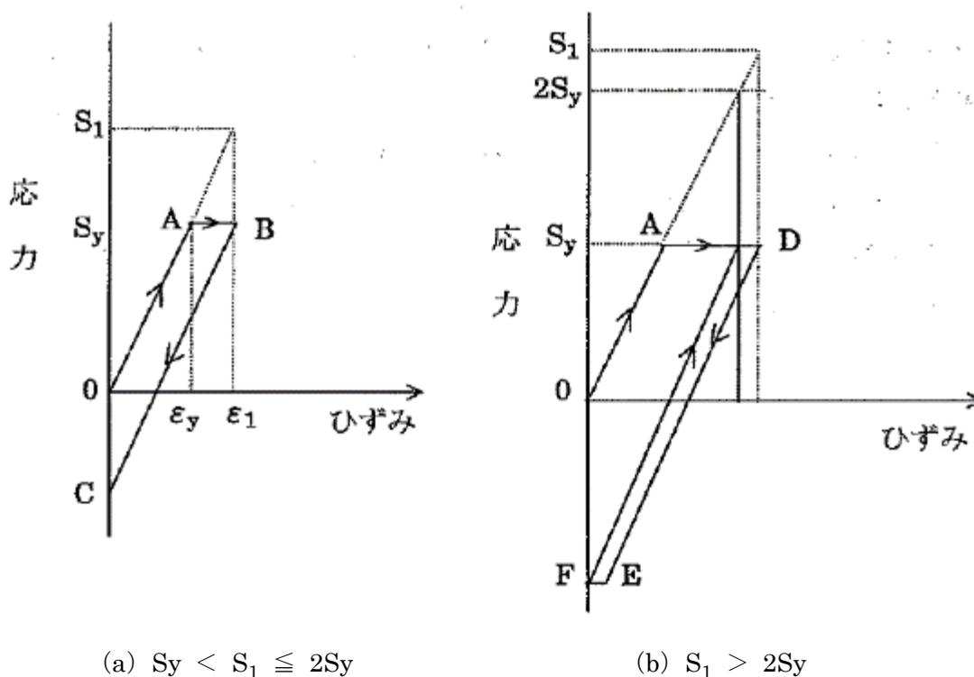
図 4 降伏点を超える場合のひずみ履歴<sup>(2)</sup>
