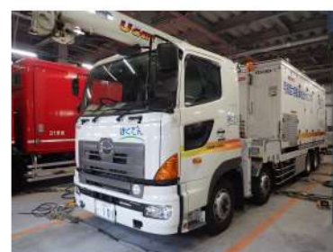
可搬型大容量 海水送水ポンプ車
