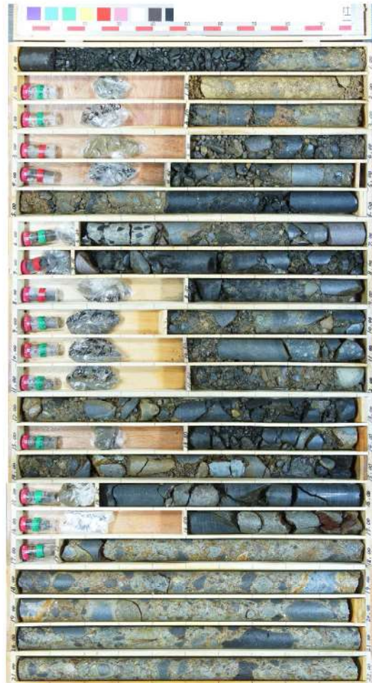
参考 1-26 図 ボーリング柱状図・コア写真 (BF3-1)
