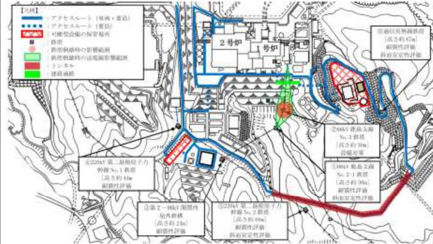
第6図 影響評価方法選定結果によるアクセスルート確保 (66kV鹿島支線, 220kV第二島根原子力幹線, 通信用無線鉄塔)
