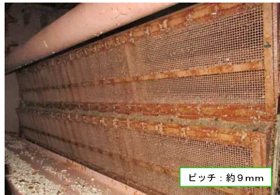
④ロータリースクリーン ピッチ：約9mm
