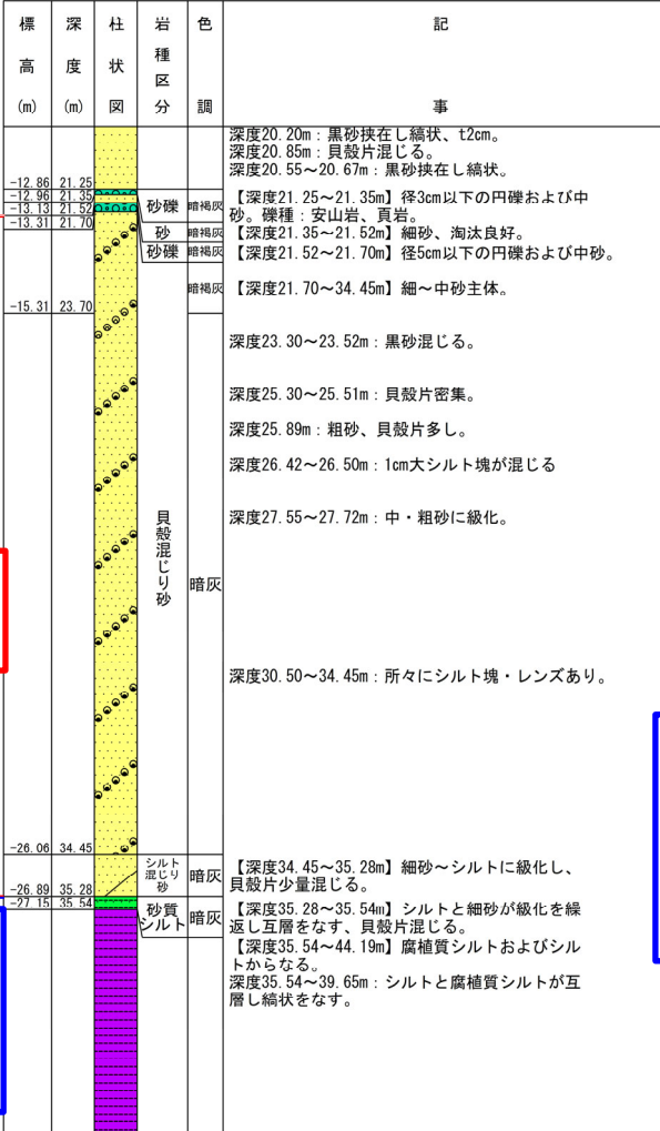
ボーリング柱状図(深度20~40m)
