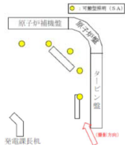
図2.5-5 シミュレータ施設における可搬型照明(SA)点灯状況
