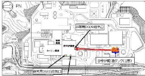
第1図 熱気流を取り込む可能性のある給気口位置（軽油タンク火災）
