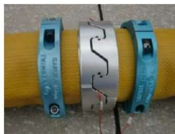
可搬型ホース(150A)接続後
