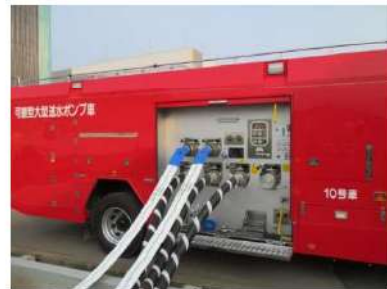
可搬型大型送水ポンプ車 周辺のホース敷設 (屋外 T. P. 31m)
