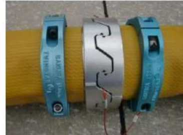
可搬型ホース(150A)接続後
