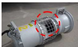
①水中ポンプの吸込み部
