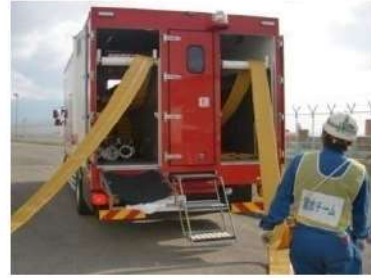
ホース延長・回収車による 可搬型ホース敷設 (屋外 T. P. 31m)
