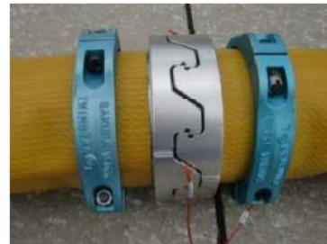
可搬型ホース (150A) 接続後
