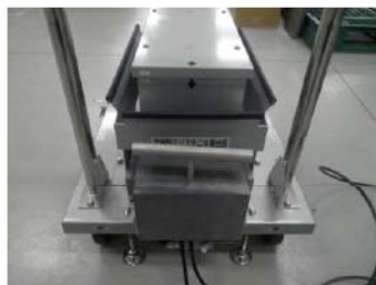
可搬型エリアモニタ 検出器側
