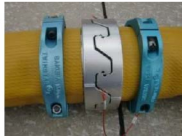
可搬型ホース (150A) 接続後
