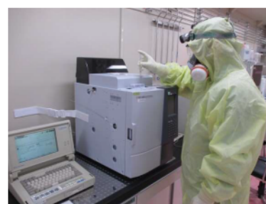
ガス分析計による水素濃度測定 (原子炉補助建屋 T. P. 6. 3m)
