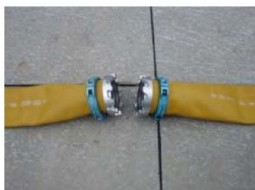
可搬型ホース (150A) 接続口
