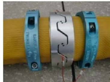
可搬型ホース (150A) 接続後
