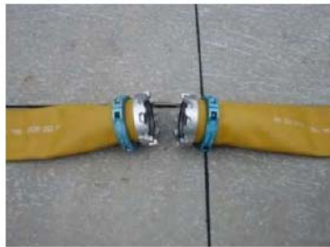
可搬型ホース (150A) 接続口
