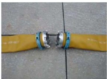
可搬型ホース (150A) 接続口
