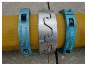
可搬型ホース(150A)接続後
