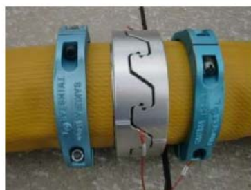
可搬型ホース (150A) 接続後
