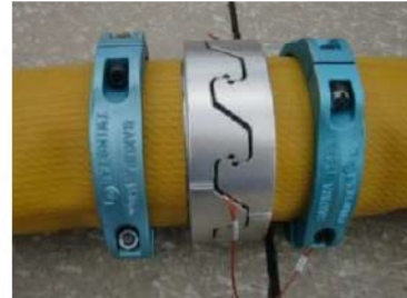
可搬型ホース (150A) 接続後
