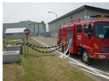
可搬型大型送水ポンプ車の設置 原水槽への吸管挿入 (屋外 T. P. 10m)
