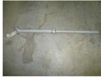
起動レバー (タービン動補助給水ポンプ室に保管)
