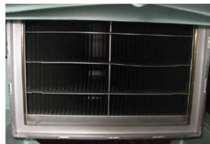
装置底部 (PAR 入口給気口)
