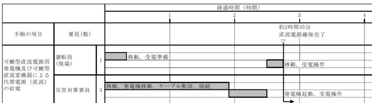
図 2.14-19 可搬型直流電源用発電機及び可搬型直流変換器による代替電源(直流)の給電のタイムチャート*
