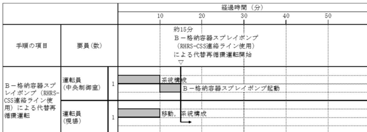
第 1.4.21 図 B-格納容器スプレイポンプ（RHRS-CSS連絡ライン使用）による代替再循環運転のタイムチャート*
