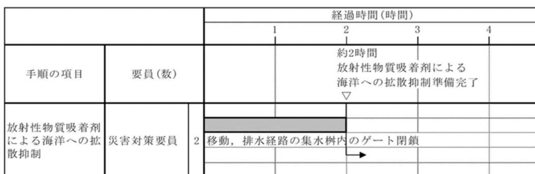
第1.12.5図 放射性物質吸着剤による海洋への拡散抑制タイムチャート※1
