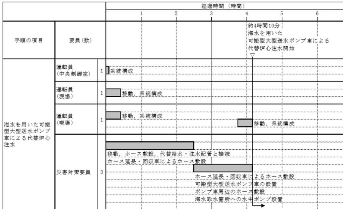
図 2.4-7 海水を用いた可搬型大型送水ポンプ車による代替炉心注水 タイムチャート*
