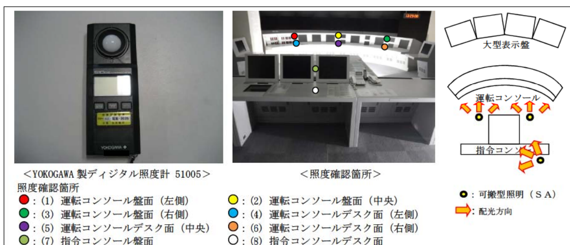
第 8-1 図 シミュレータにおける可搬型照明 (S A) 確認状況
