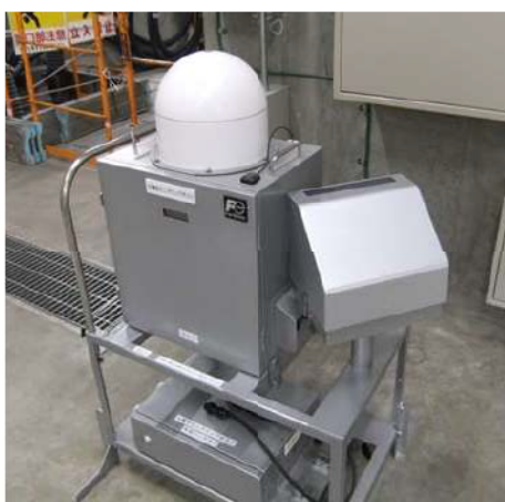
図2-23 可搬型モニタリングポスト（設置イメージ）
