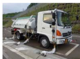
可搬型タンクローリー
