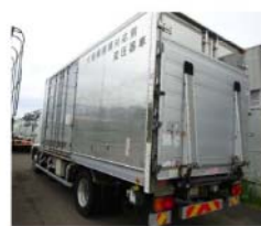
大規模損壊対応用変圧器車
