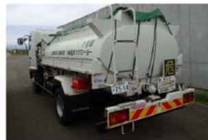
可搬型タンクローリー
