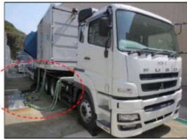
空冷式非常用発電装置の固縛対策 (写真)
