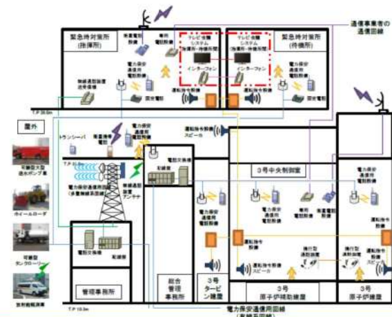
図2 通信設備（発電所内）の概要〔通信設備（発電所外用）と共用のものを含む〕
